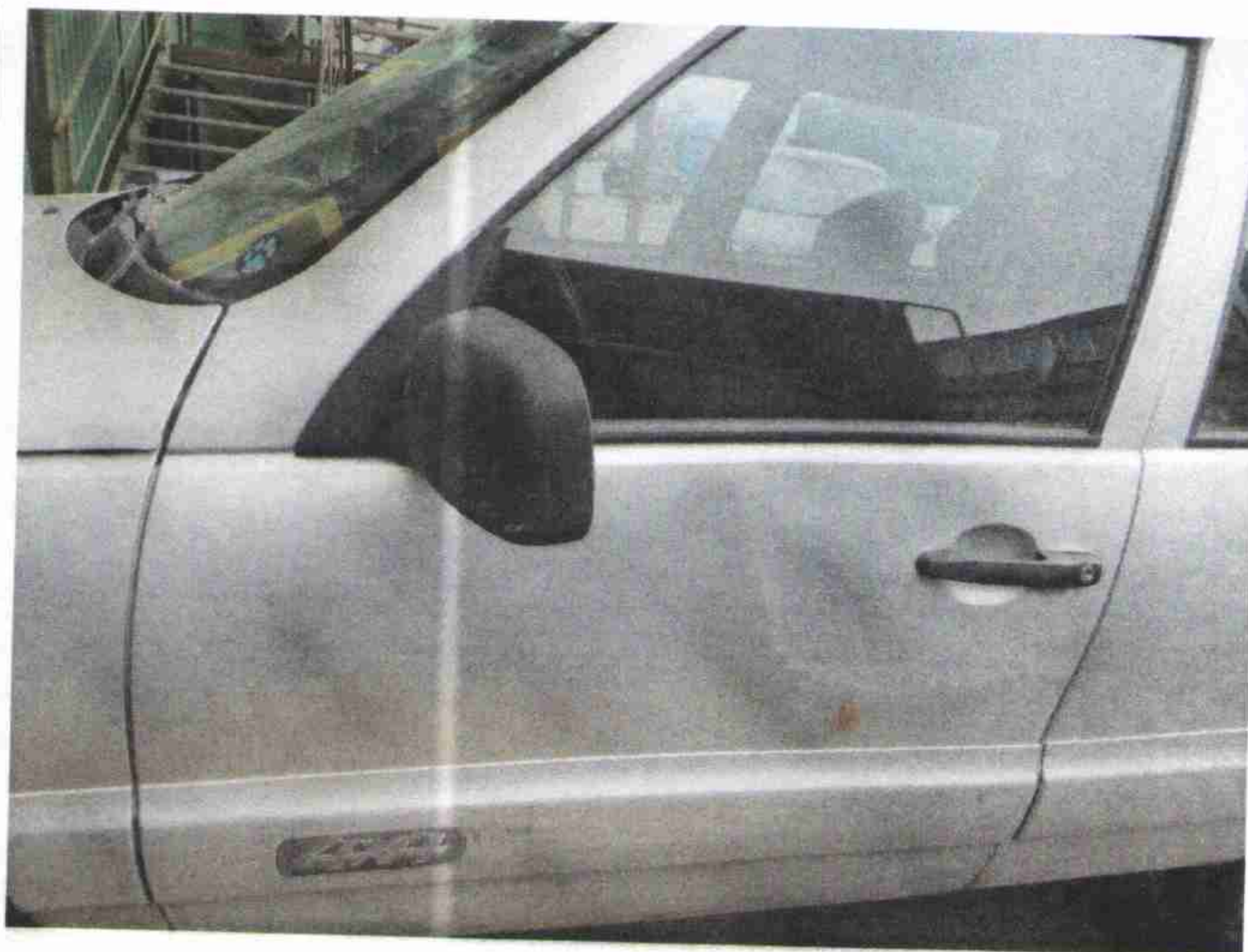
Фото №№ 7,8 «Капот – следы коррозии, стесы ЛКП. Дверь водительская – вмятины, следы коррозии»
