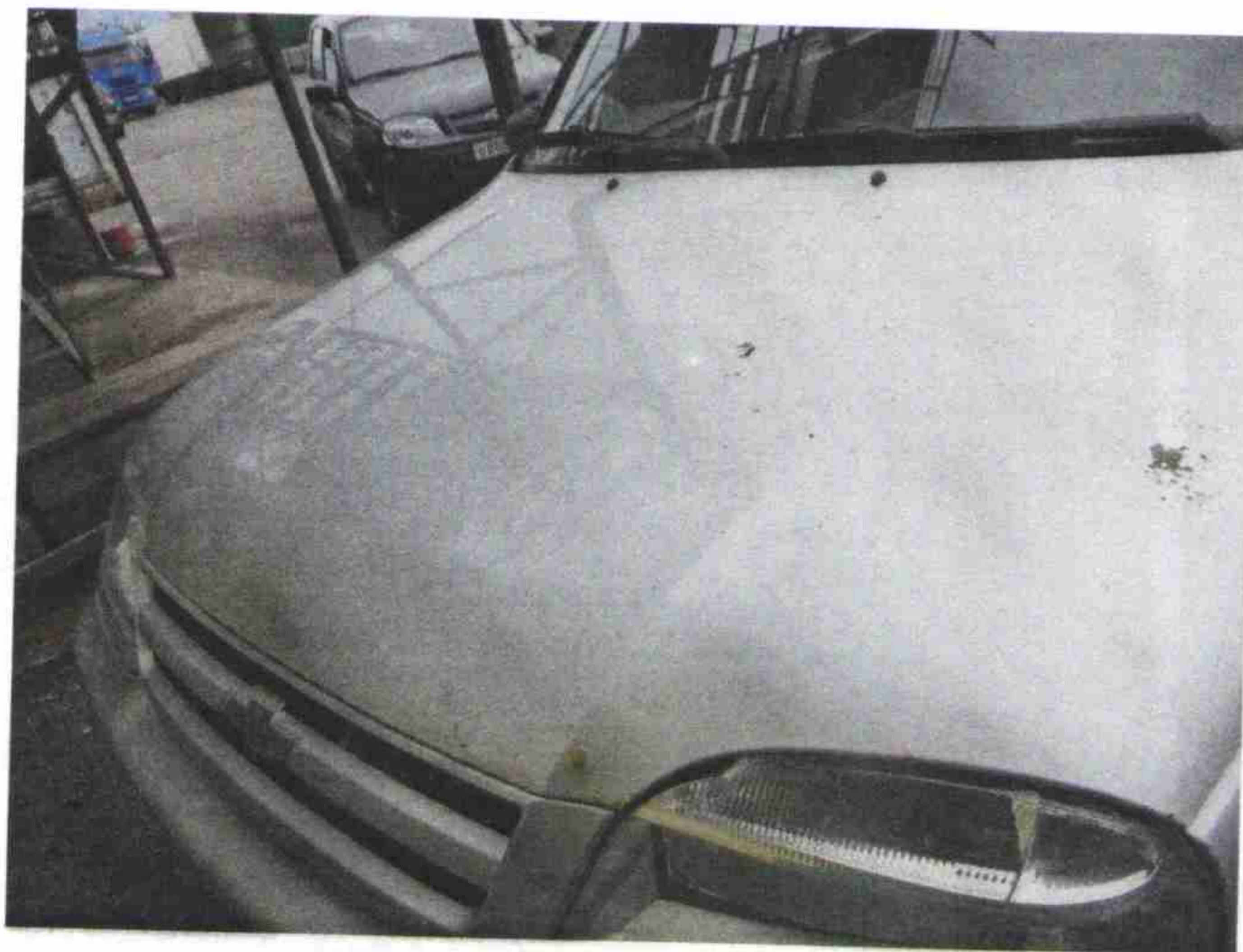
Фото №№ 7,8 «Капот – следы коррозии, стесы ЛКП. Дверь водительская – вмятины, следы коррозии»
