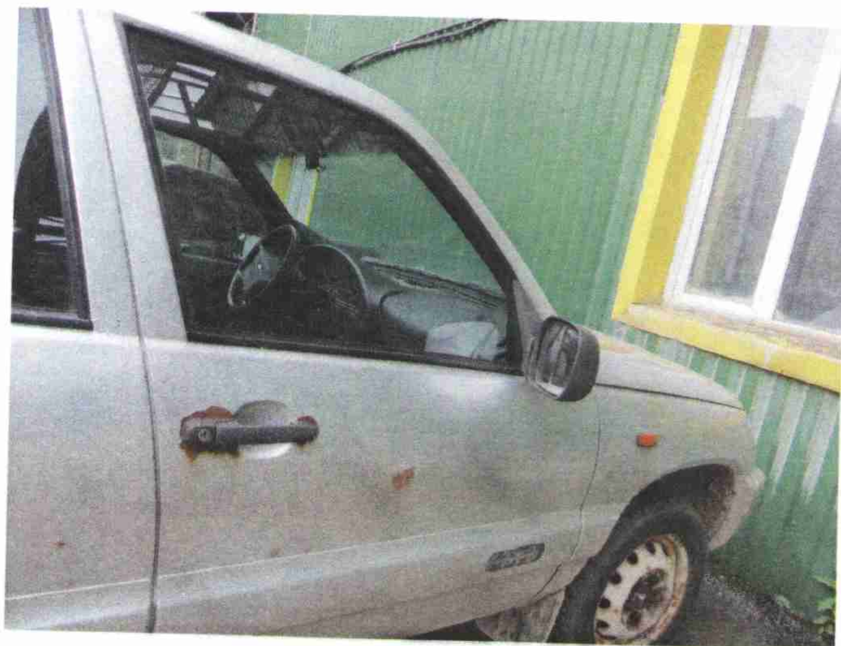
Фото №№ 9-12 «Дверь зад. левая – следы коррозии. Дверь пассажирская – следы коррозии. Дверь зад. правая – следы коррозии. Дверь задка – вмятины, следы коррозии. Бампер задний – расколот»
