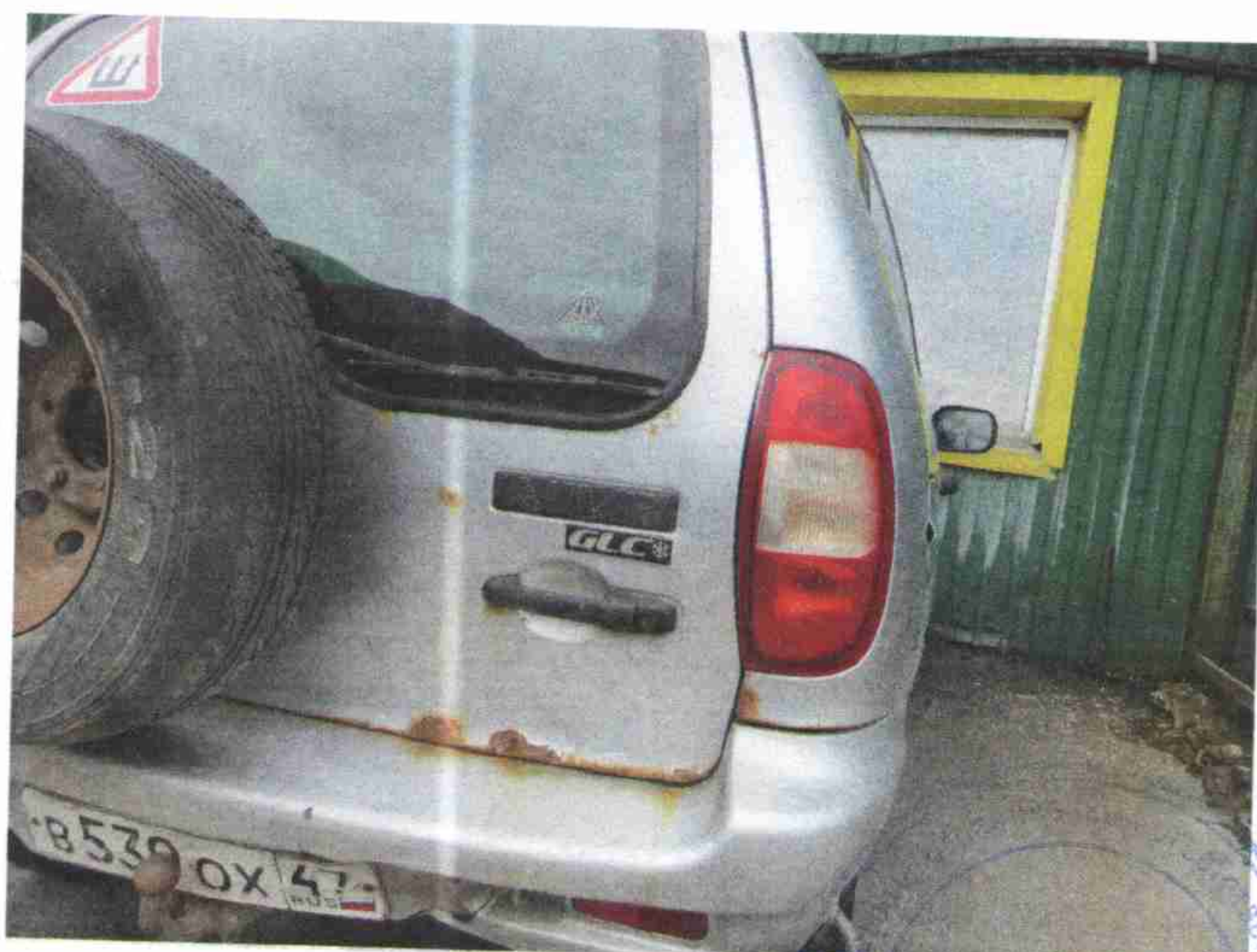
Фото №№ 9-12 «Дверь зад. левая – следы коррозии. Дверь пассажирская – следы коррозии. Дверь зад. правая – следы коррозии. Дверь задка – вмятины, следы коррозии. Бампер задний – расколот»
