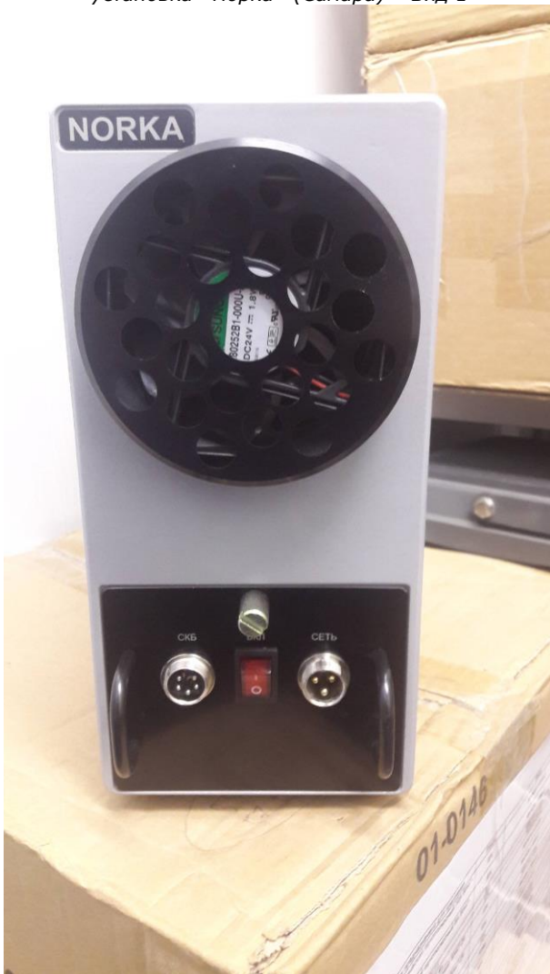
Фотография 21. Переносная рентгенотелевизионная установка «Норка» (Самара) – Вид 1
