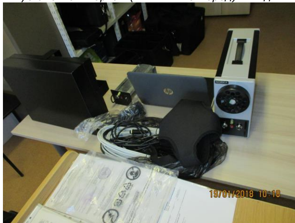
Фотография 22. Переносная рентгенотелевизионная установка «Норка» (Самара) – Вид 2
