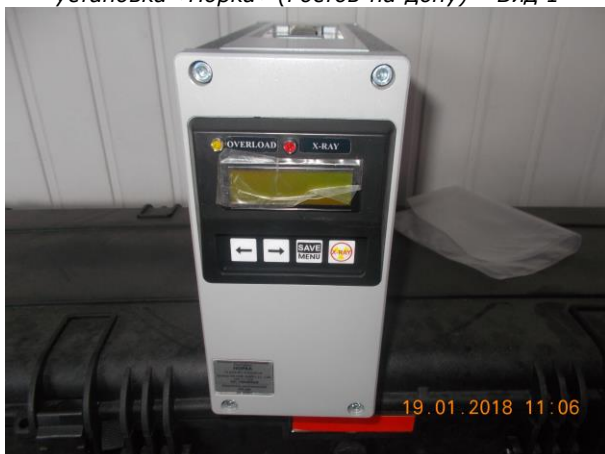
Фотография 15. Переносная рентгенотелевизионная установка «Норка» (Ростов-на-дону) – Вид 3
