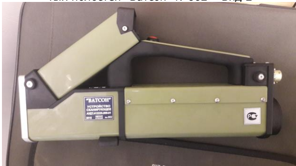
Фотография 36. Сканер ручной рентгеновский скрытых полостей "Ватсон" №668 – Вид 2
