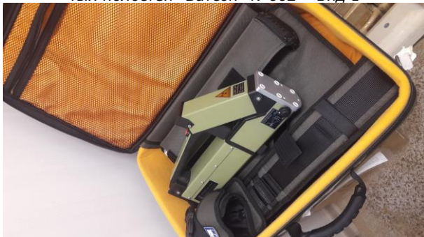
Фотография 35. Сканер ручной рентгеновский скрытых полостей "Ватсон" №668 – Вид 1
