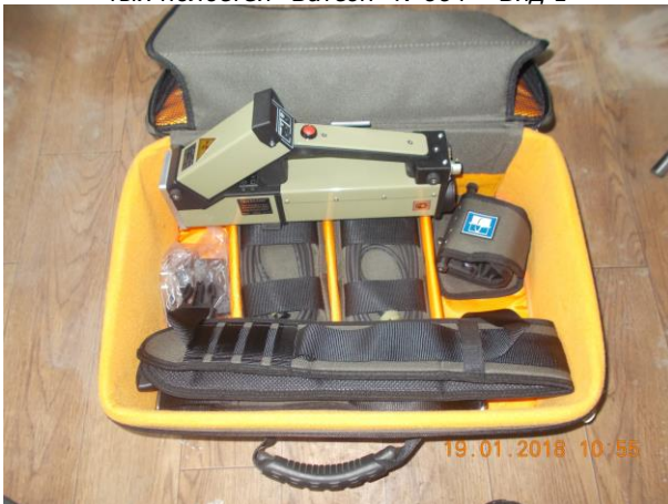
Фотография 29. Сканер ручной рентгеновский скрытых полостей "Ватсон" №664 – Вид 1
