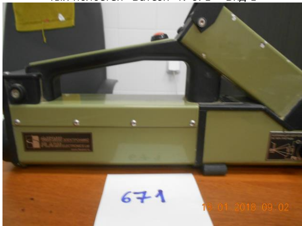
Фотография 17. Сканер ручной рентгеновский скрытых полостей "Ватсон" №671 – Вид 1
