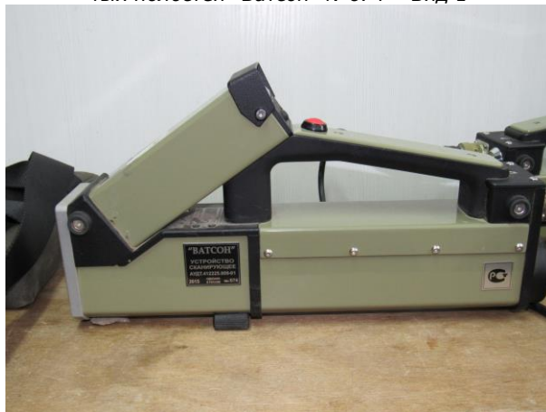
Фотография 40. Сканер ручной рентгеновский скрытых полостей "Ватсон" №674 – Вид 1
