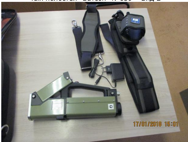
Фотография 24. Сканер ручной рентгеновский скрытых полостей "Ватсон" №659 – Вид 2
