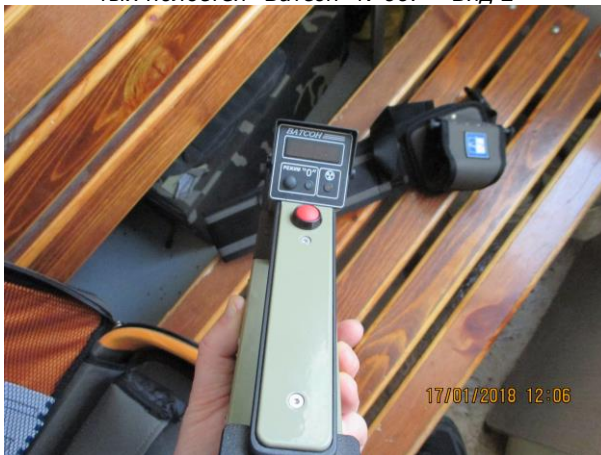
Фотография 28. Сканер ручной рентгеновский скрытых полостей "Ватсон" №659 – Вид 2
