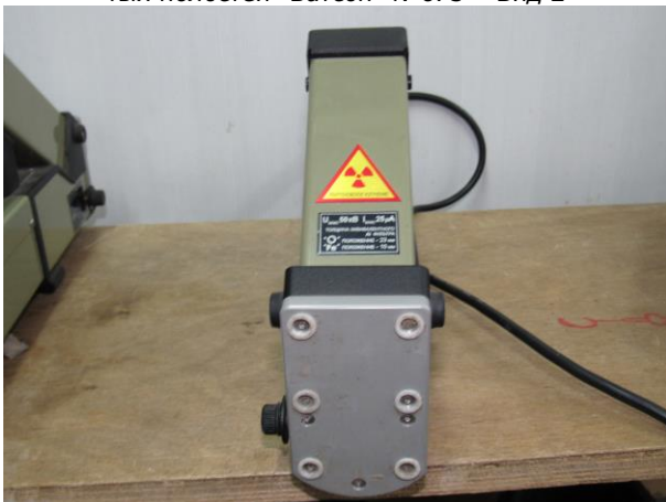
Фотография 39. Сканер ручной рентгеновский скрытых полостей "Ватсон" №673 – Вид 2
