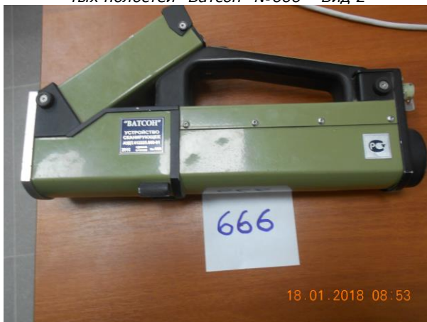
Фотография 22. Сканер ручной рентгеновский скрытых полостей "Ватсон" №656 – Вид 2
