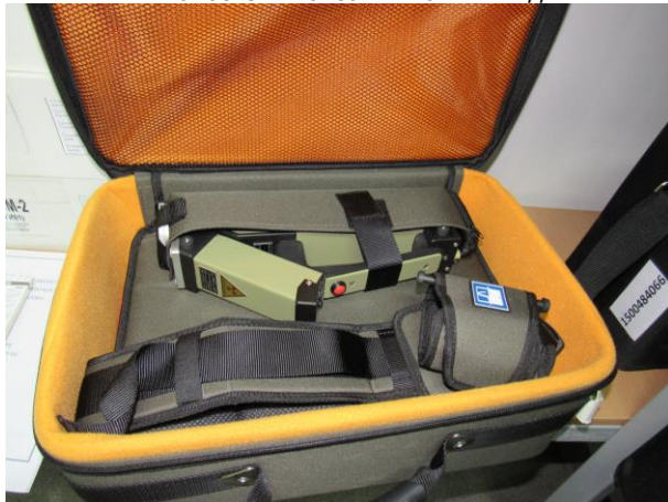
Фотография 37. Сканер ручной рентгеновский скрытых полостей "Ватсон" №672 – Вид 1
