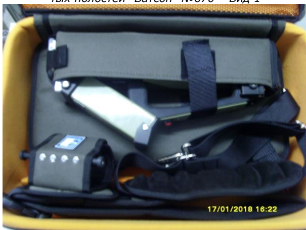
Фотография 11. Сканер ручной рентгеновский скрытых полостей "Ватсон" №660 – Вид 1
