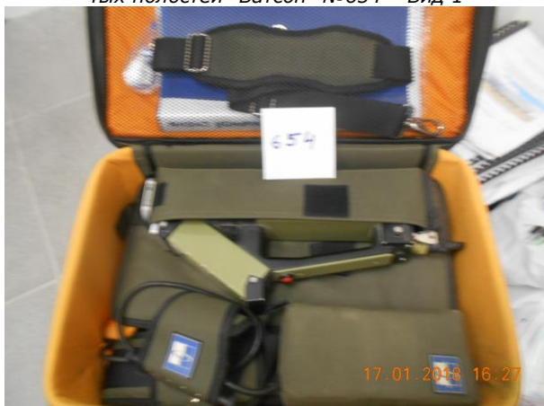
Фотография 15. Сканер ручной рентгеновский скрытых полостей "Ватсон" №657 – Вид 1
