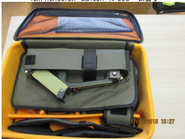
Фотография 23. Сканер ручной рентгеновский скрытых полостей "Ватсон" №658 – Вид 1
