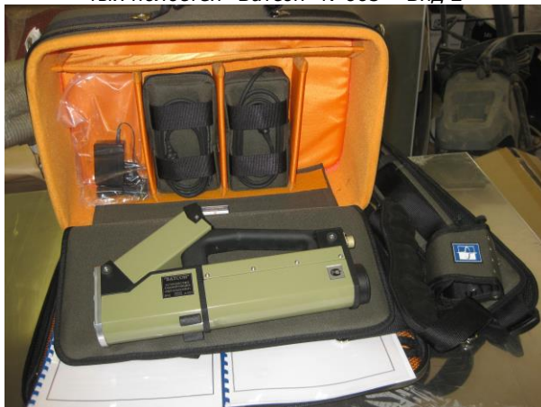
Фотография 6. Сканер ручной рентгеновский скрытых полостей "Ватсон" №669 – Вид 2
