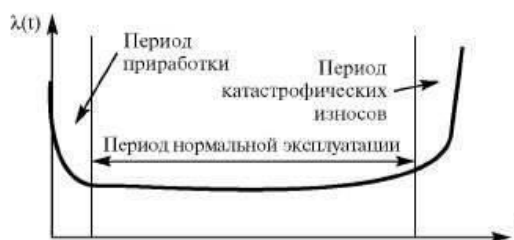
Рис. 1. Изменение интенсивности отказов за время эксплуатации машины
